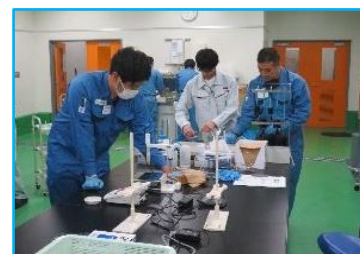
アンモニア性窒素測定 (イオンメーター)
