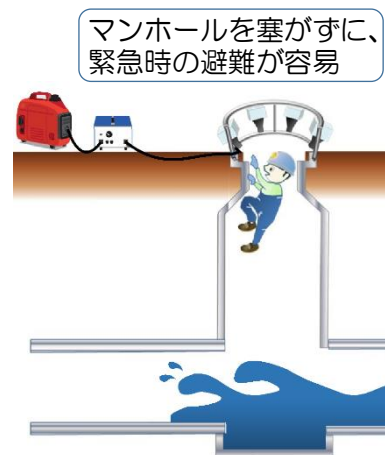
ホールエアストリーマの換気方式
