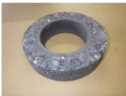
5%濃度硫酸水溶液に 112 日間浸漬した後の状況写真 (左：e-CON 右：普通コンクリート)
